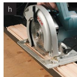
Retirez la partie inférieure de la rainure femelle sur le côté et le bout de la lamelle.
